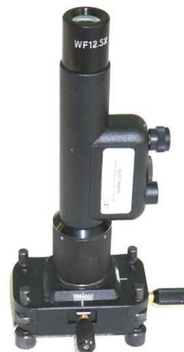
Специальные магнитные держатели надежно фиксируют микроскоп на вогнутых, выпуклых и плоских стальных поверхностях (трубах, гибах и т.п.).
